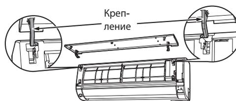
1. Вставьте ось левого крепления вдоль плоскости устройства в отверстие.
