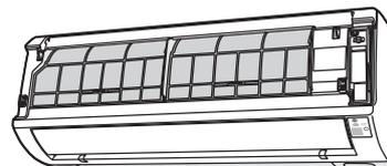
**2** Удалите пыль с фильтра при помощи пылесоса. Если пыли слишком много, помойте фильтр чистящим средством и затем тщательно промойте водой. После этого высушите его в тени.
